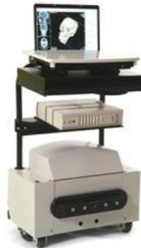
**Modo Escaneo:** El tomógrafo se coloca en el cabezal de la cama y mediante una unidad de ciempiés, es el tomógrafo es quién se mueve en dirección opuesta a la de la cama mientras realiza el escaneo. Por ende, al contrario de cualquier otro tomógrafo, la cama del paciente queda quieta y el mismo recorre el área a escanear.
